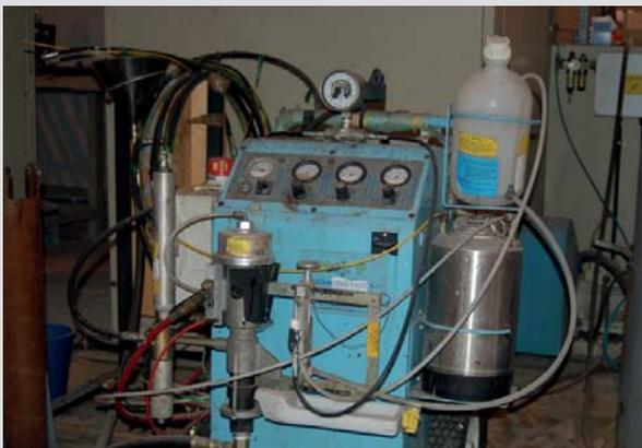
Combinado presión de inyección y el vacío con resinas poliéster, epoxy, fenólica y poliuretano.
