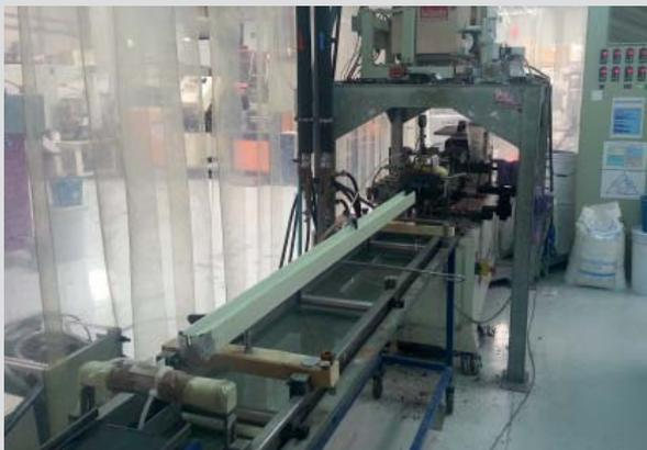
**Línea de compounding:** Fabricación de lotes de formulaciones termoplásticas: 50-100 kg/semana. Obtención de pellets y micropellets
